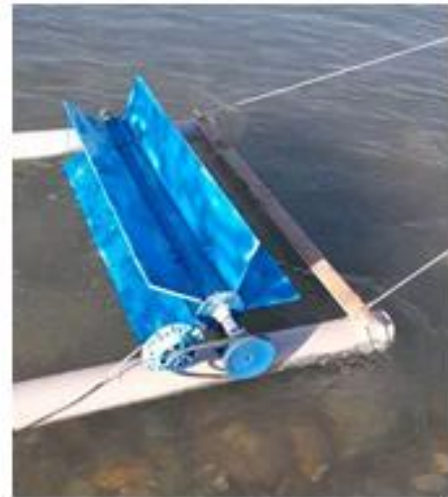
1-rasmda. Suvda suzuvchi girlyandli mikro gidroelektrostansiya.
