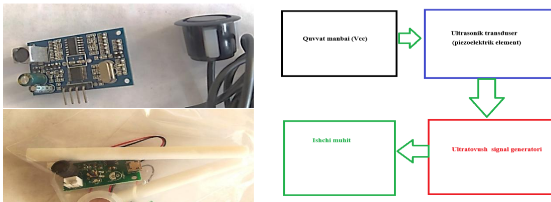
1-Rasm. Ultratovushli texnologiya uchun tanlangan elektronika jamlanmasi
